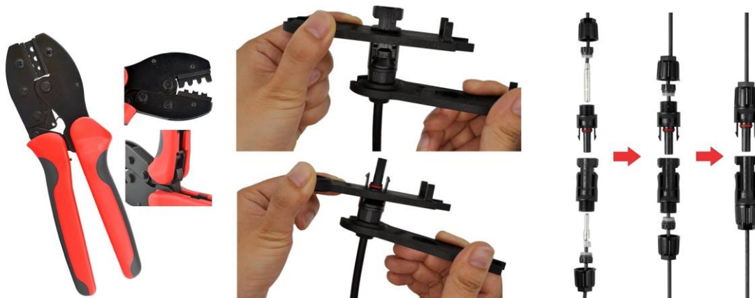
Figura 2.12. Crimpadora, herramienta de apriete y forma de armar conector.
