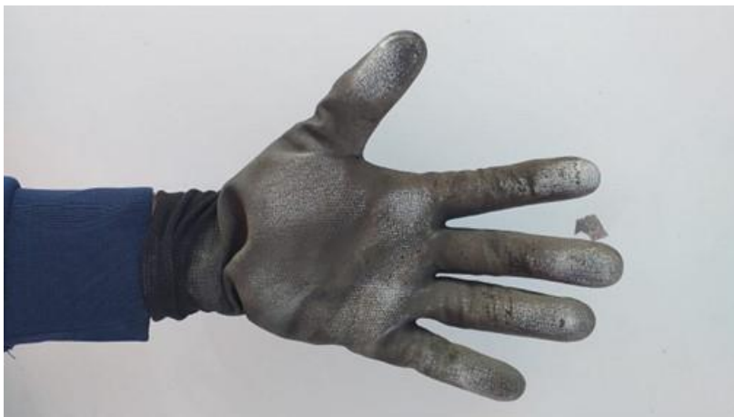
Figura 7.7. Polvo blanco proveniente de una capa trasera degradada
