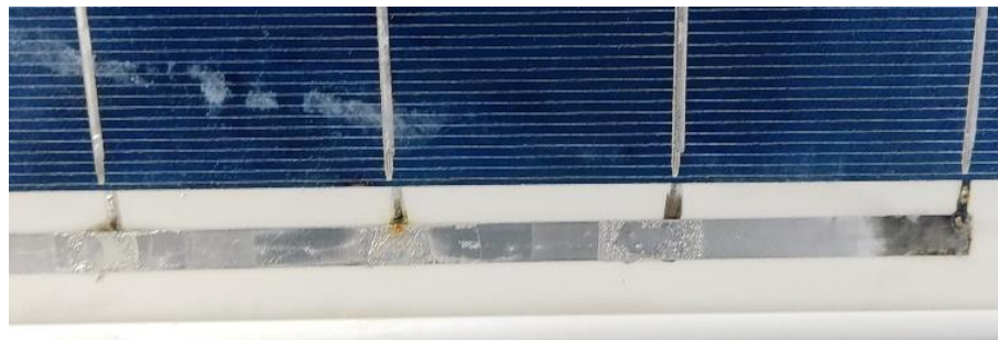
Figura 7.15. Quemadura en los puntos de unión entre ribbons de celda y ribbon de string.
