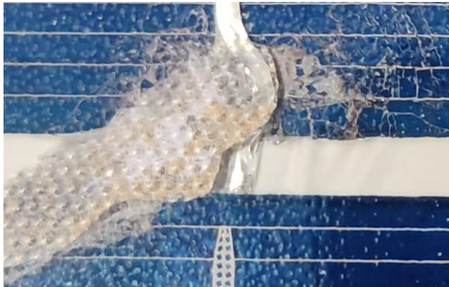
Figura 7.14. Cinta de interconexión de celdas rota.
