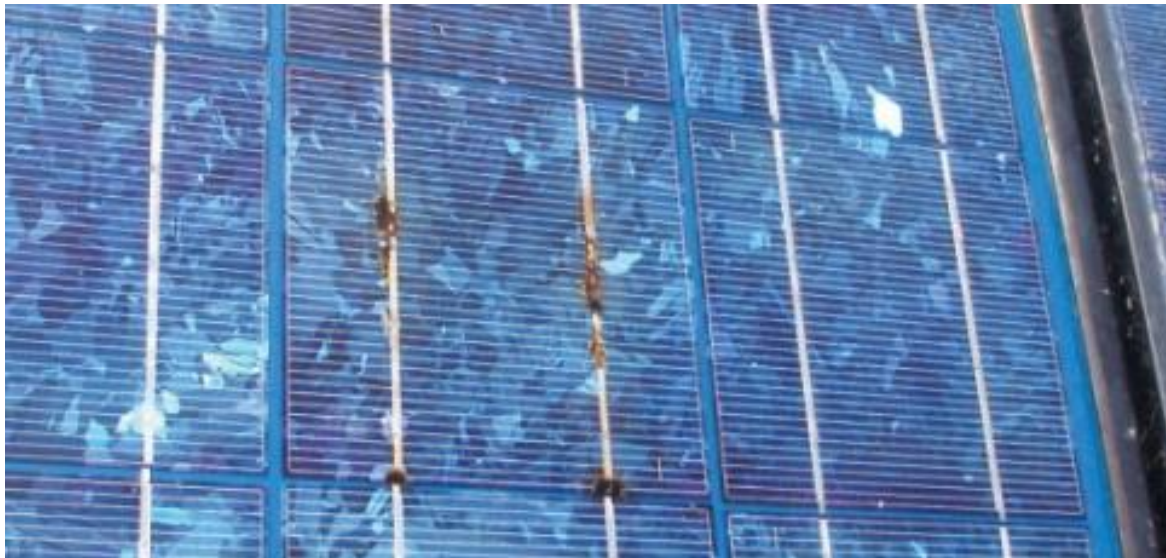
Figura 7.12. Corrosión en la metalización de una celda de silicio policristalino. 6
