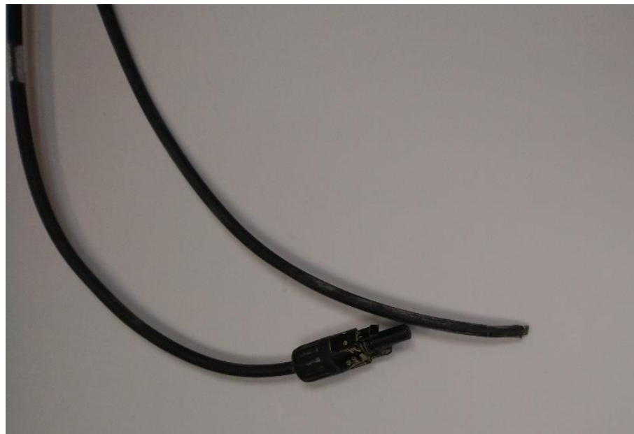
Figura 7.23. Módulo con un conector faltante.
