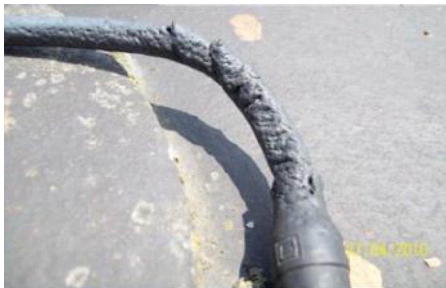
Figura 7.22. Cable mordisqueado por un animal 8
