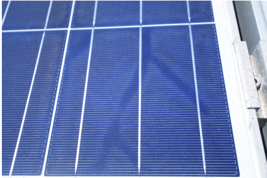
Figura 7.41. Snail tracks en un módulo de silicio.
