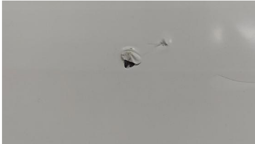
Figura 7.11. Rotura de la capa trasera.
