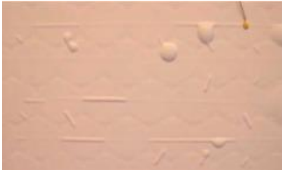
Figura 7.9. Burbujas pequeñas en la capa trasera 4
