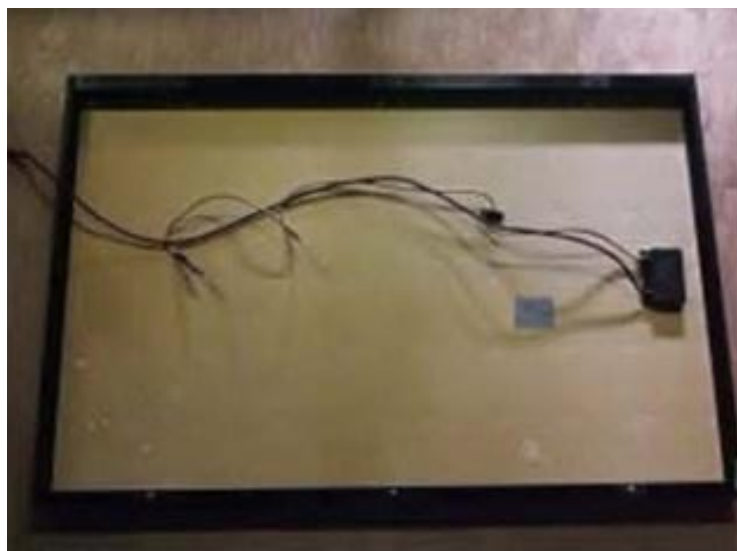
Figura 7.6. Decoloración severa de la capa trasera 3
