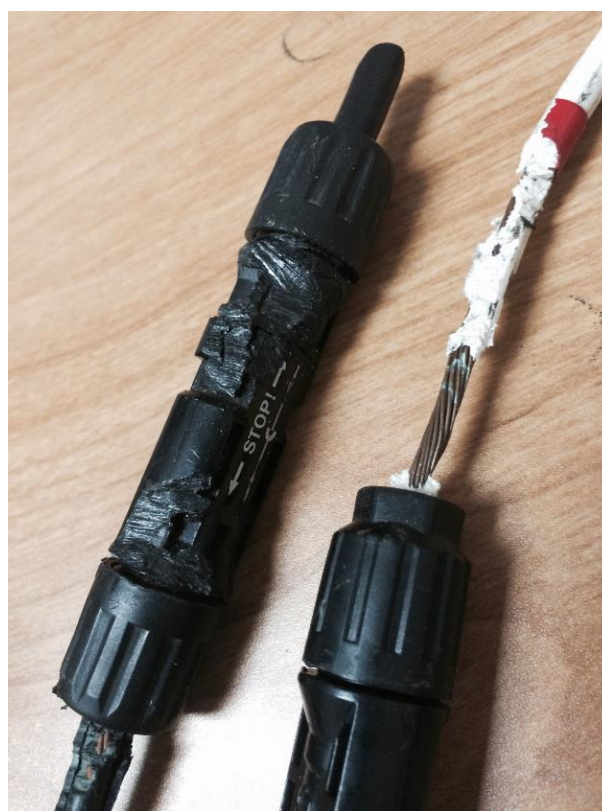
Figura 7.28. Conector y cable roídos por un animal 10
