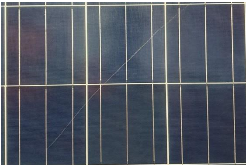
Figura 7.1. Rayas en el vidrio delantero de un módulo FV
