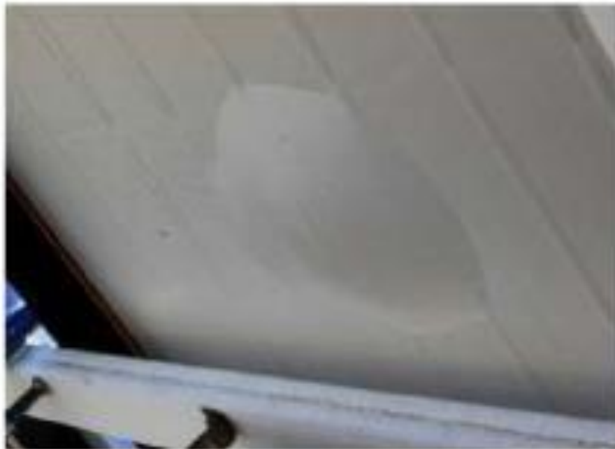
Figura 7.10. Delaminación de la capa trasera manifestada como una burbuja de grandes dimensiones 5
