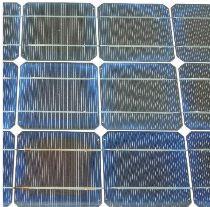
Figura 7.38. Decoloración del encapsulante en celdas de silicio 14
