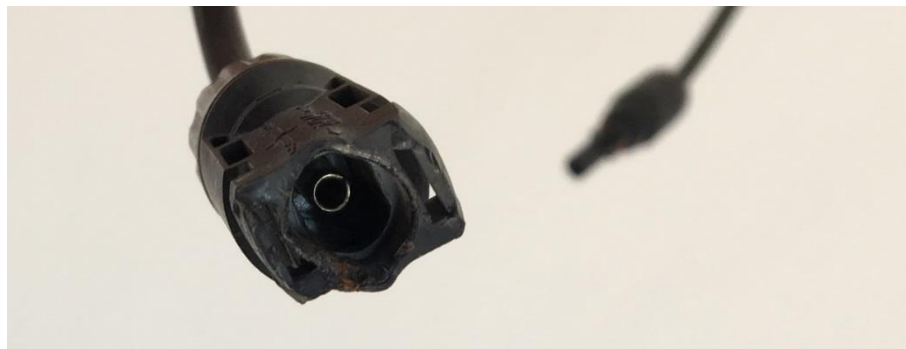
Figura 7.26. Conector aplastado, degradado pero funcional.
