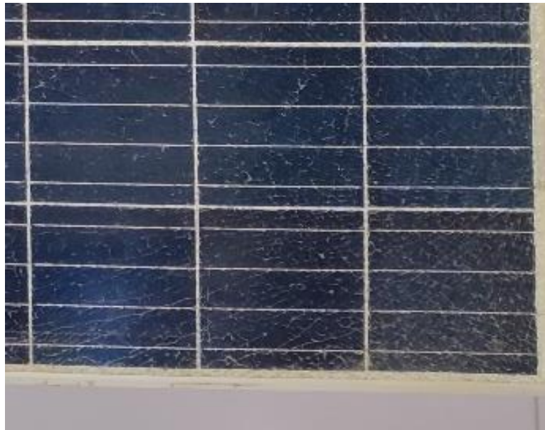
Figura 7.2. Vidrio templado roto
