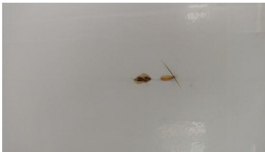
Figura 7.8. Marca de quemadura en la capa trasera
