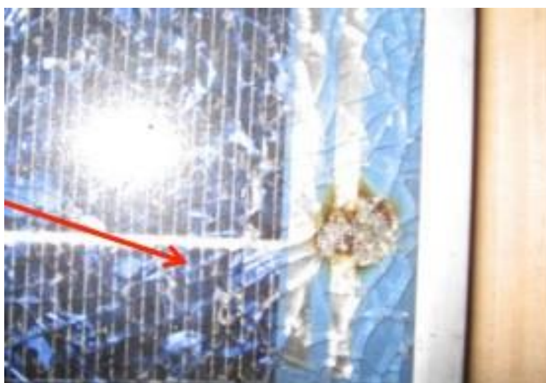
Figura 7.16. Marcas de quemadura.
