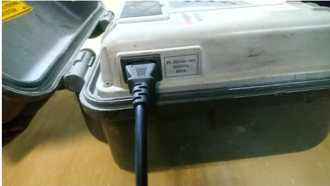
Figura 3.7. Conexión del cable de alimentación al megaóhmetro.
