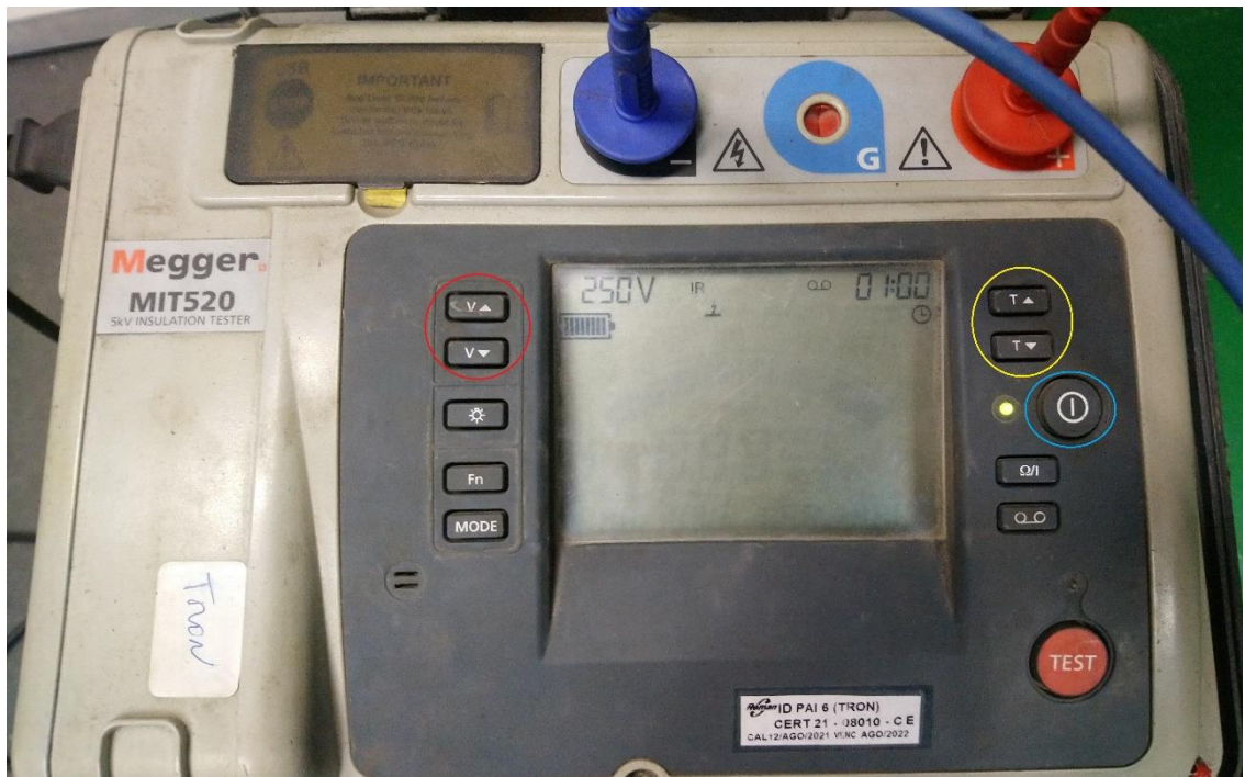
Figura 3.8. Megaóhmetro listo para operar.
