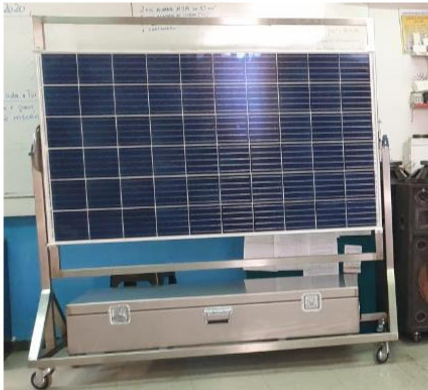
La estructura del rack, posee un marco giratorio ajustable a distintas inclinaciones dependiendo de la localización geográfica de cada establecimiento, a fin de optimizar la irradiación solar. Para el caso del conjunto de los 6 paneles de 53W, se recomienda realizar 3 string cada uno con dos paneles o 2 string cada uno con tres paneles, cuyos parámetros de voltaje y corriente están dentro de los rangos de entrada tanto para la experiencia on-grid, como para la off-grid.
