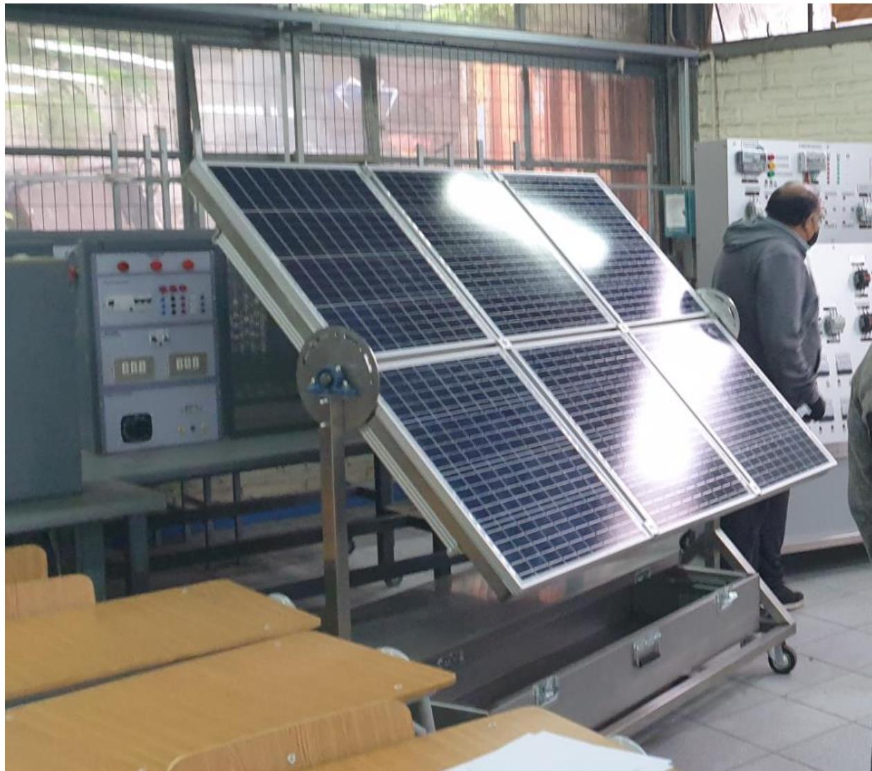
2.3.- Cada Rack fotovoltaico trae una caja de acero inoxidable con ruedas para guardar y trasladar de manera fácil los equipos y materiales correspondientes a cada banco.
