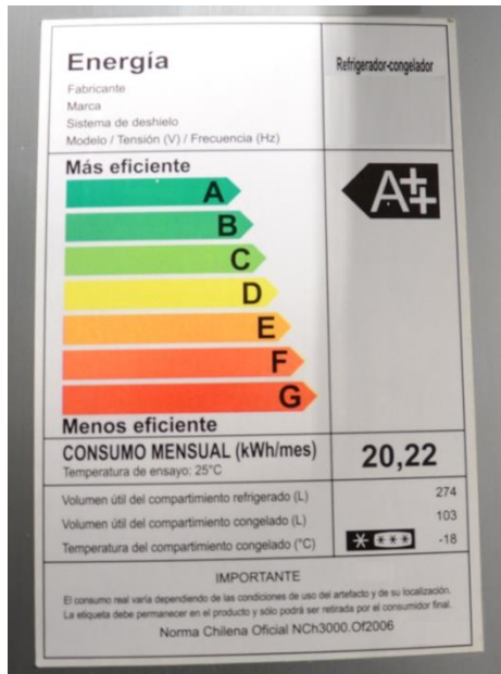
Figura 9: Etiqueta Chilena para refrigeradores y límites de eficiencia energética según la norma NCh3000 de 2006. Elaboración propia.
