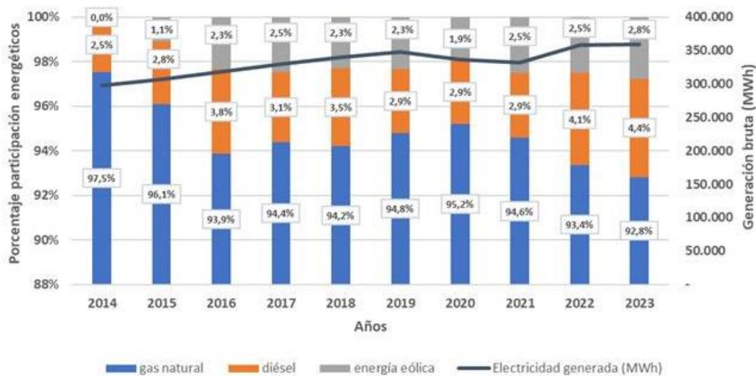
Figura 8 Generación Bruta de electricidad (MWh) y porcentaje de energéticos utilizados en la Región de Magallanes y la Antártica Chilena (2014 - 2023).
