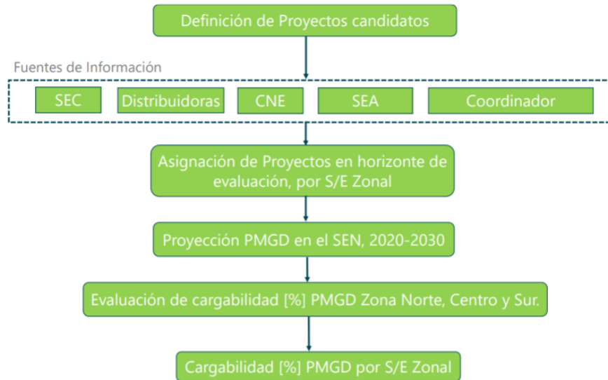
Figura 16: Diagrama de Flujo Proyección PMGD periodo 2020-2040. Fuente: (CNE, 2021)
