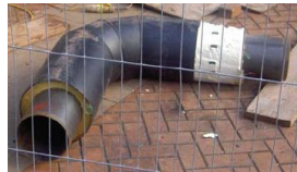
Imagen 1.1. Tubería de calefacción distrital.
