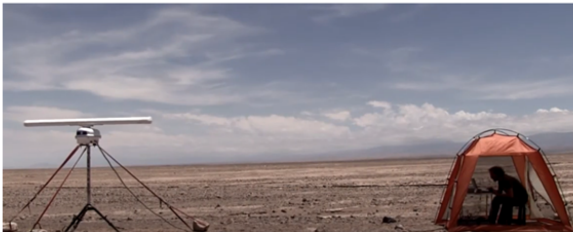
Figura 14. Radar marino modificado GEM SuperNet utilizado para el estudio de gaviota garuma en Chile. Fuente: https://youtu.be/G37VWG8lhn8
