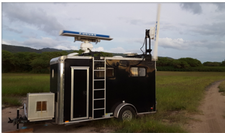
Figura 13. Laboratorio de radar de Hamer Ambiental. Nótese su portabilidad y la presencia de dos antenas: una horizontal y una vertical. Foto: Thomas Hamer/Hamer Environmental.
