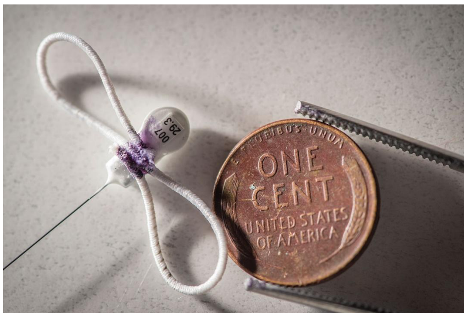
Figura 9. Nano-etiqueta de radio utilizada en los proyectos MOTUS. Foto: Tim Romano/Instituto Smithsonian de Biología de la Conservación.
