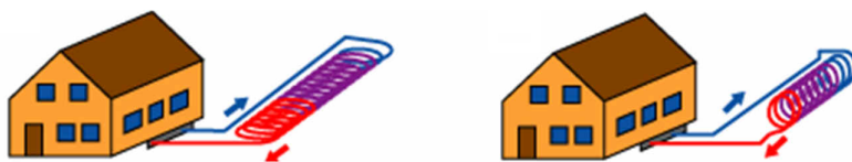
Figura 48. Intercambiadores Slinky : tipología rizada horizontal a la izquierda y tipología rizada vertical a la derecha. Fuente: [46].
