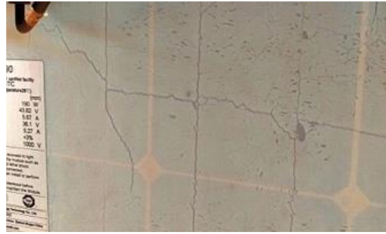
Fig. 6.6: MFV con capa trasera ( backsheet ) roto.
