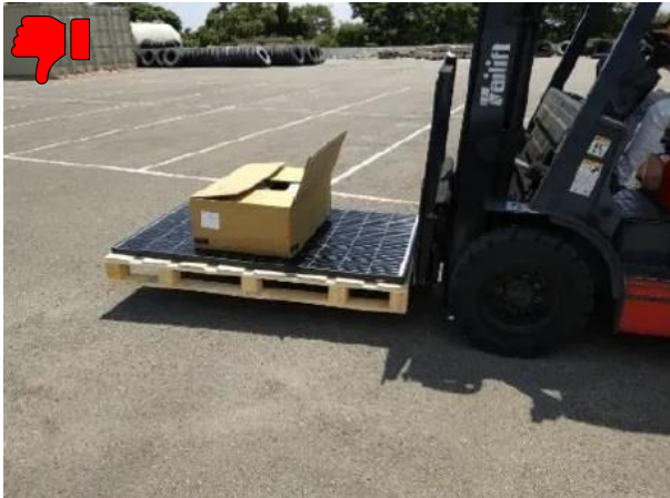
Fig. 6.1: MFV siendo transportado con un inversor (en su caja) apoyado sobre él. 18
