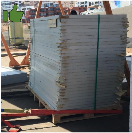
Fig. 6.17: MFV correctamente paletizados siendo recogidos por un montacargas
