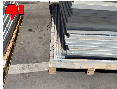
Fig. 6.12: MFV al fondo de una pila con su vidrio frontal roto debido al exceso de carga ejercido sobre su cara frontal.
