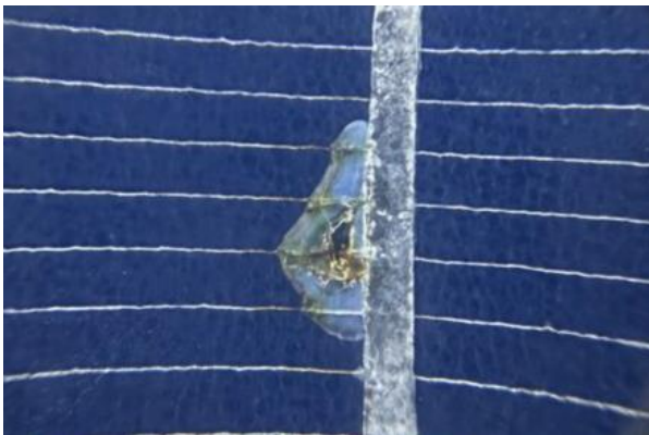
Fig. 6.7: MFV con marcas de quemadura.
