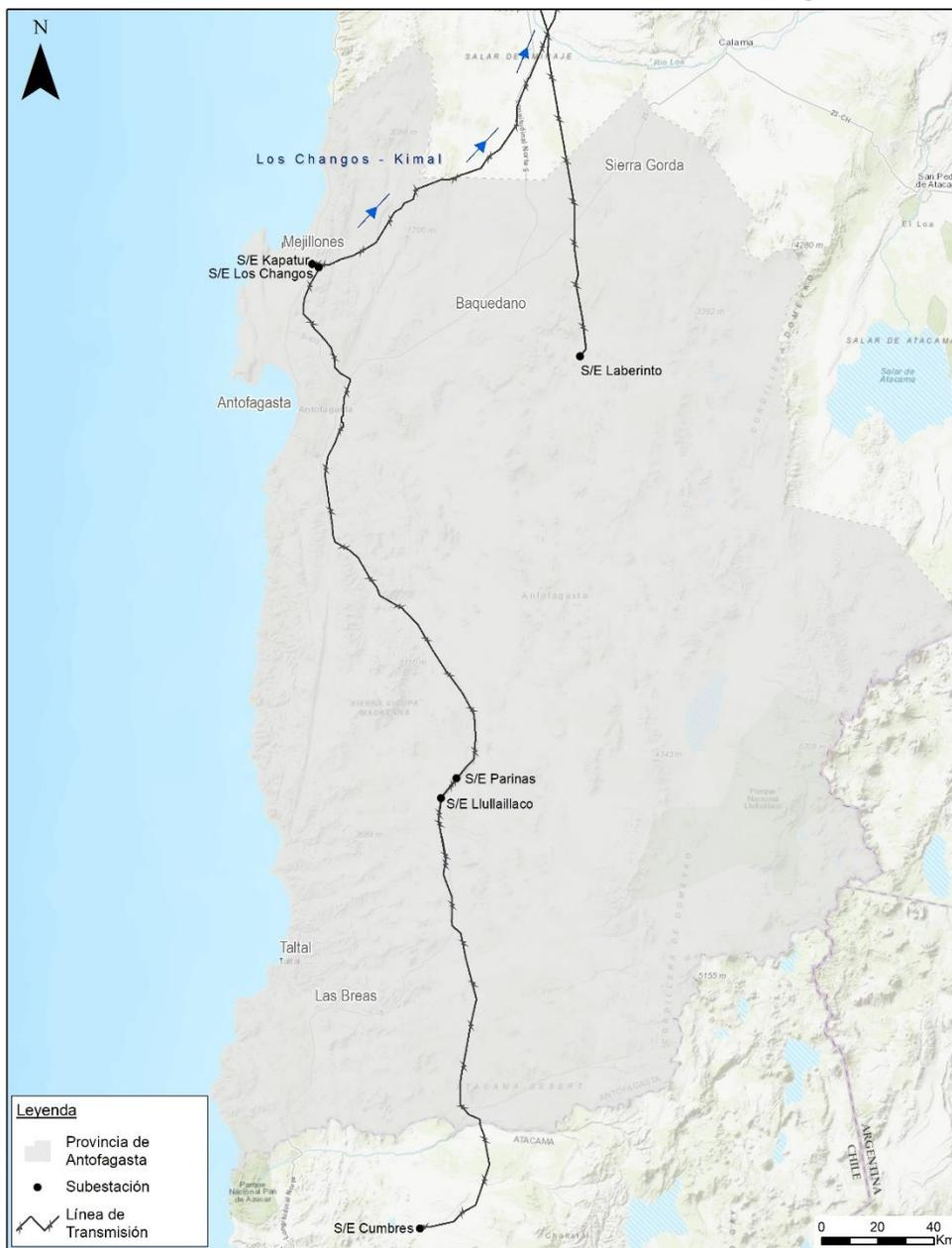
Para la evacuación del potencial CSP y fotovoltaico de la zona más cercana a la subestación Kimal, se tienen como posibles nodos de evacuación la subestación Miraje 220 kV y Encuentro 220 kV. Para el potencial de la comuna de Sierra Gorda, se estima necesario hacer uso de la Línea 2x500 kV Kimal – Los Changos, ya sea a través de nuevas obras de transmisión para polos de desarrollo que seccionen dicha línea o líneas que conecten esta zona con la subestación Kimal 500 kV.
