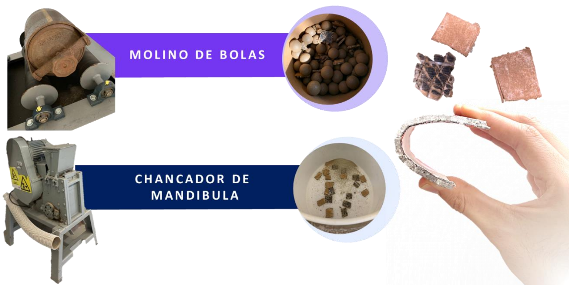
Fig. 2 Pruebas de equipos de conminución de PV en molienda y chancado.
