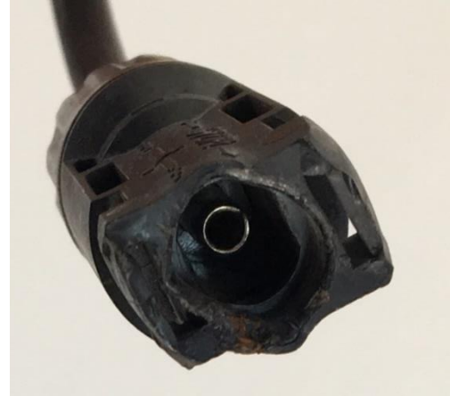
Fig. II.2. Conector dañado por aplastamiento
