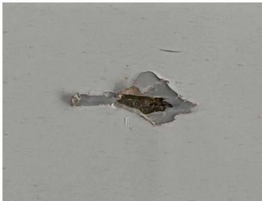
Fig. II.10. Backsheet rota que expone la celda
