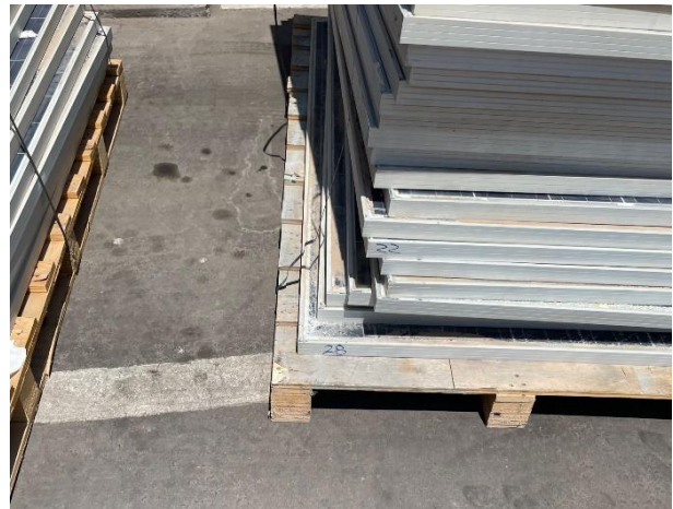
Fig. III.8. MFV al fondo de una pila con su vidrio frontal roto debido al exceso de carga ejercido sobre su cara frontal
