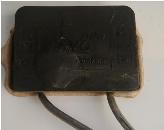
Fig. II.4. Jbox con la tapa rota
