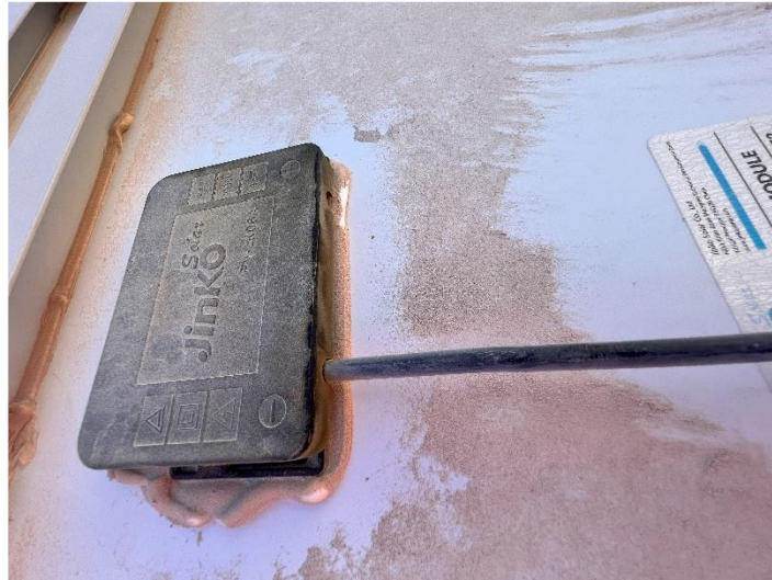
Fig. II.3. MFV con un cable arrancado
