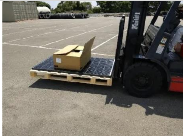
Fig. III.1. MFV siendo transportado con un inversor (en su caja) apoyado sobre él. 7
