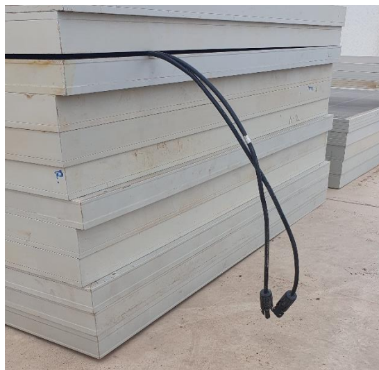
Fig. III.10 Cables atrapados entre 2 MFV dentro de una pila
