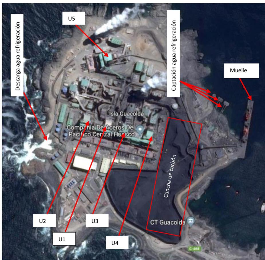
Figura 25: Complejo termoelectrico Guacolda. Fuente: Elaboración propia.
