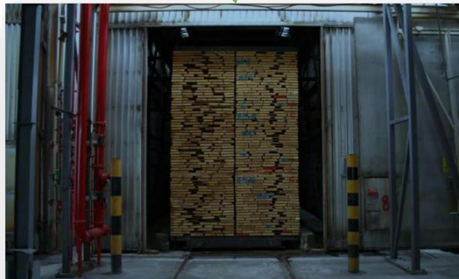
*Secador de madera, Central Geotérmica Taupo, Nueva Zelanda*
