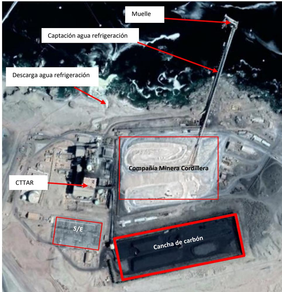
Terminal Marítimo Patache, propiedad de Compañía Minera Cordillera, es usado para el **embarque de sal** y para la **descarga de carbón**.
